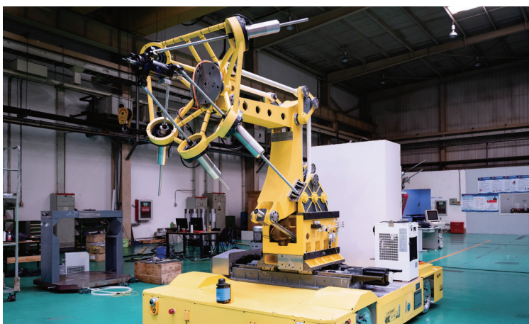
首创的移动式混联加工机器人。
